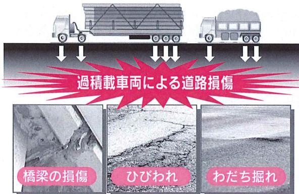
大型車両1台が、軸重10トンの基準よりも2トン超過した場合、橋梁に対しては約9台分の加重が蓄積され、道路が損傷する原因になります。
